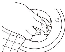
3. フードタンク、ステンレスディッシュを薄めた中性洗剤を含ませたスponジで洗浄し、十分に洗い流す。水気をふき取り、しっかり乾燥させる。
