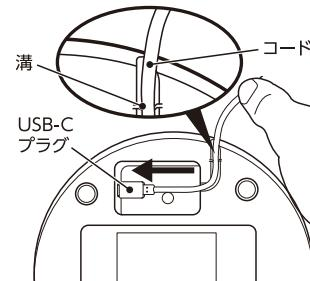
1. USBケーブルのUSB-Cプラグを、本体底面のポートに差し込み、コードを溝に押し込む。
